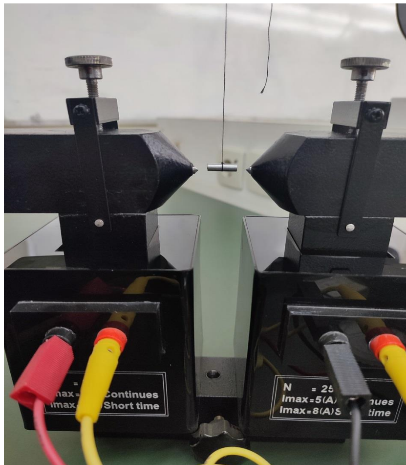
شکل ۱- میله مغناطیسی در راستای میدان مغناطیسی خارجی واقع شده است.
