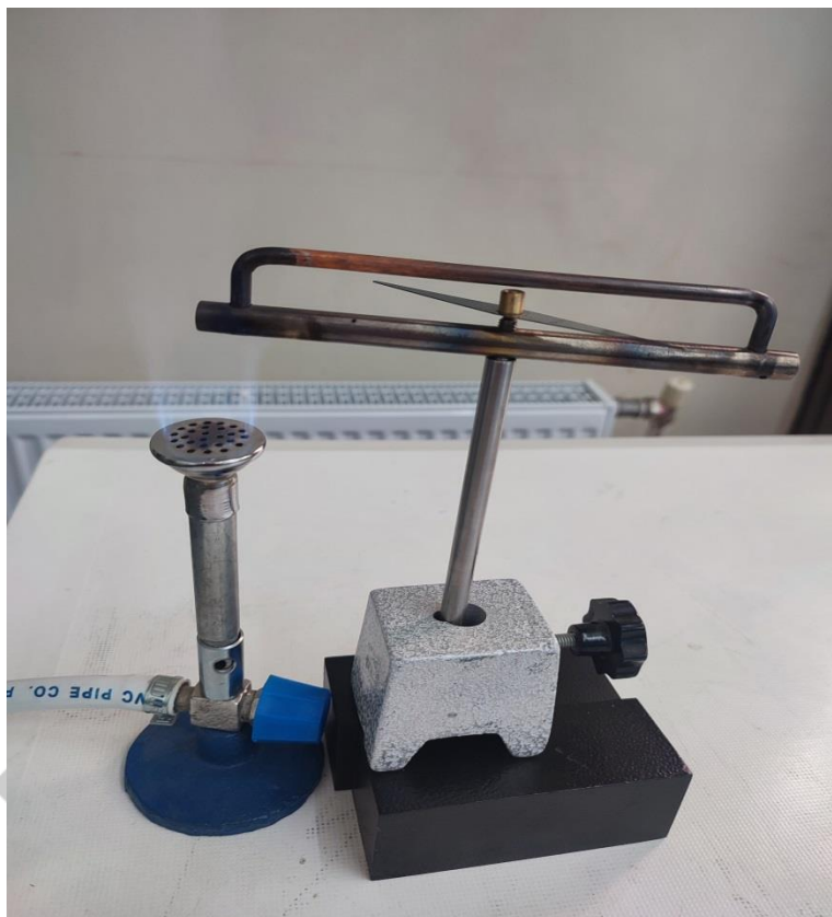
شکل (۲) مطالعه ترموکوپل با عقربه مغناطیسی
